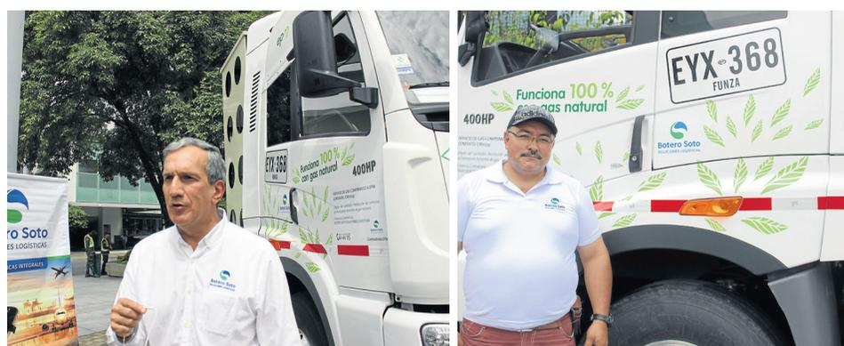
ración: tienen motor de 12 lt dedicado a gas natural comprimido (GNC), potencia de 400 HP turbocargado con Intercooler y almacenamiento de 280 m3 de GNC, gracias a sus 8 cilindros con sistema de cargue rápido, lo cual le brinda una autonomía de aproximadamente 500 km según la ruta.
